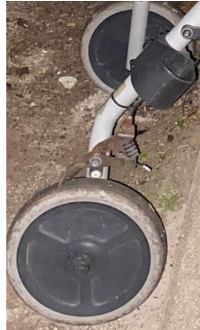
Abbildung 24: Rostige Rollatorbremse an kassenüblichen Modell (Schmucker 2021)
